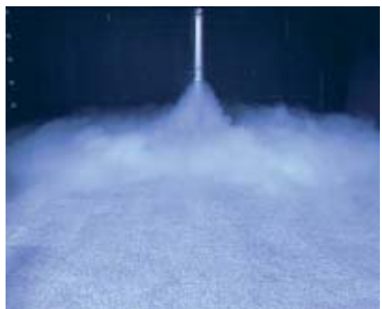
Quellauslaß Typ QR-SA - 1000 - Ø 400, 360° ausblasend V_{Zu} = 700 \text{ m}^3/\text{h} \Delta T = -4\text{K}
