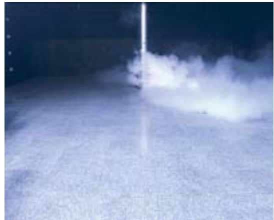
Quellauslaß Typ QR-SA - 1000 - Ø 400, 180° ausblasend V_{Zu} = 700 \text{ m}^3/\text{h} \Delta T = -4\text{K}
