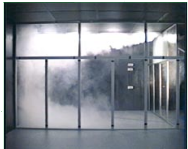
Zu- und Abluftkombinationsauslaß KWVB-S im Rauchversuch Länge 1000 mm, V_{Zu/Ab} 100 m 3 /h \Delta T = -8K
